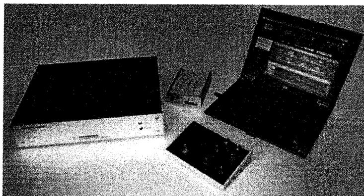
Jedná sa o externý systém pripojiteľný k širokému množstvu elektrónových transmisných mikroskopov. Zariadenie pozostáva z externého kamerového systému TEM A1/10 vrátane riadiacej jednotky na zber dát, systému DigiSTAR – elektronického modulu na ovládanie funkcií TEM a softvérových modulov: TEMDPA, DIFFGEN, INDEX a MAP VIEWER. Počítač a všetok ponúkaný softvér pracuje na báze operačného systému Windows. Ďalej ponúkame všeobecný materiál pozostávajúci zo sady držiakov.
