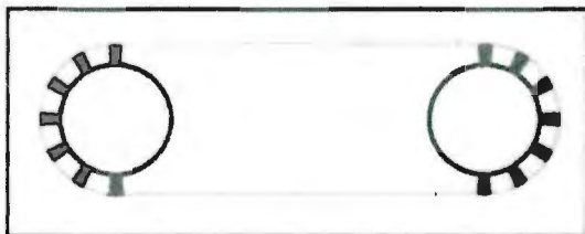
Obr. 7 Doporučený spôsob inštalácie podkladnicovej väzby nekonečnou smyčkou (2.3.11)
