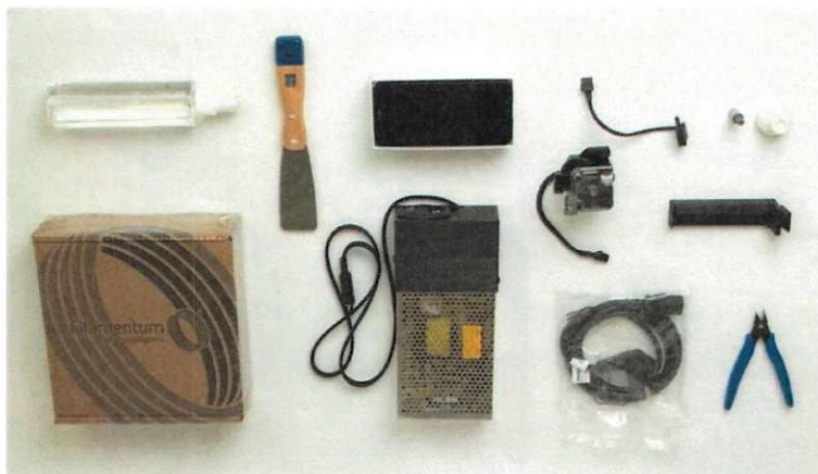
Obr. 1 Komponenty a náradie 3D tlačiarne (E3D Titan extrúder, Držiak filamentu, Snímač filamentu, Šesťhranný bit na uvoľnenie / utiahnutie trysky, Momentový kľúč s potlačou na šesťhranný bit, Fľaša s technickým alkoholom, Špachtľa, Kliešte, Cievka filamentu).
