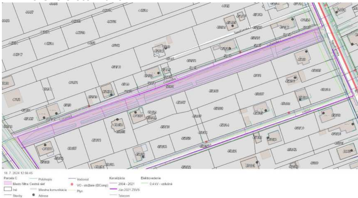
obr. 5 Zákres inžinierskych sietí v technickej mape, pozn.: zákres je orientačný, zdroj: MsÚ Nitra
