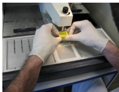
Obrázok 7 zalievanie vzorky parafínom do plna
