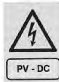
Obr.1 Označenie pre DC kábelové kanály
