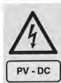
Obr.1 Označenie pre DC kábelové kanály
