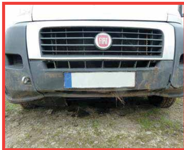
Poškodenie hnacieho ústrojenstva – únik prevádzkových kvapalín
