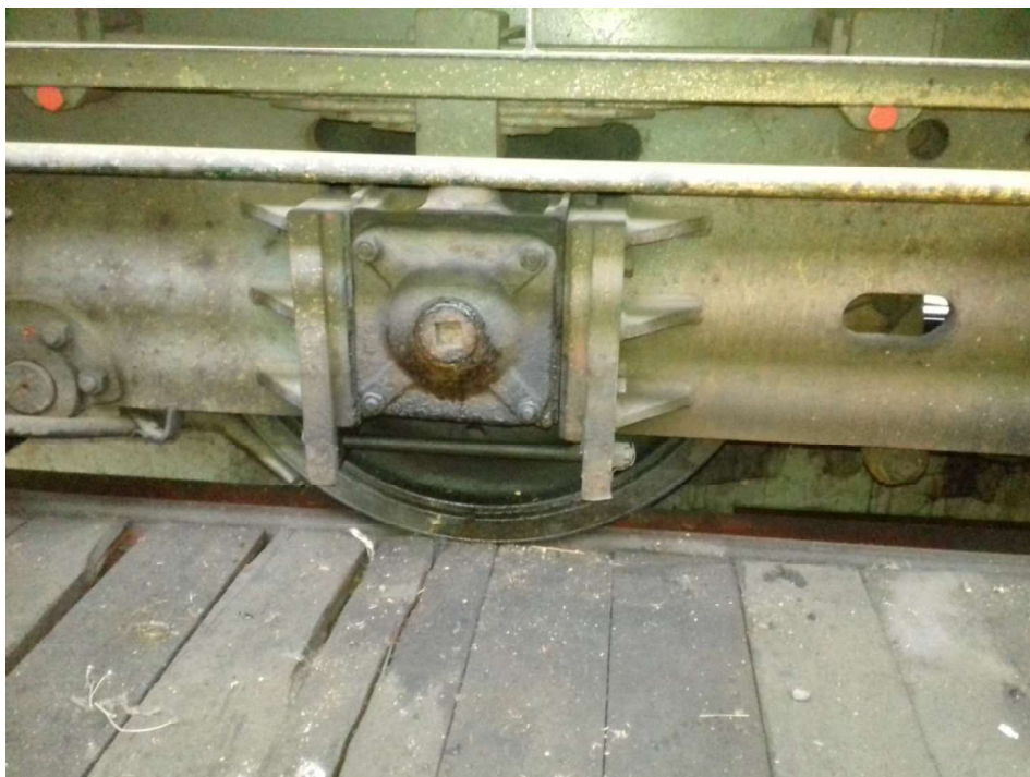
Rozsochy vedenia dvojkolesia, ložiskový domec a listová pružnica primárneho vzpruženia
