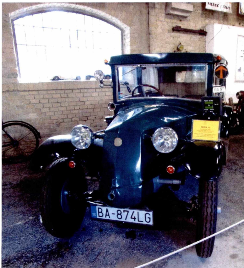
Osobný automobil TATRA 12 – bratislavské taxi, rok výroby: 1928, farba: zelená, objem valcov motora: 1056 cm 3
