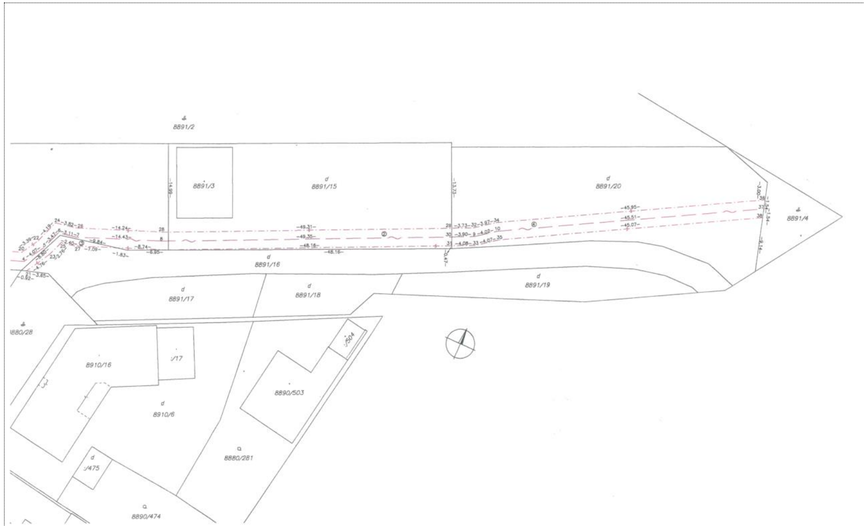
Obr. 2 Situácia na podklade grafickej časti Geometrického plánu č. 96/2014 s vyznačením vedení ŽSR a ich ochranných pásem v lokalite žst. Lozorno
