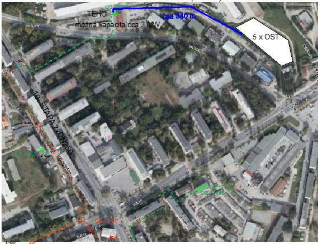
Príloha č. 1 - Situácia územia s návrhom zásobovania teplom Obytného súboru Park Anička
